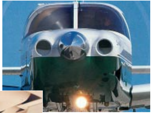
Le nouveau capot et les travaux aéro sur le train et les volets améliorent nettement les performances à partir du Saratoga II HP.
