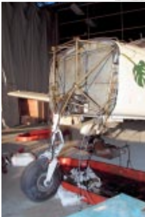
Echange d'un moteur Lycoming sur un Cherokee Six.
