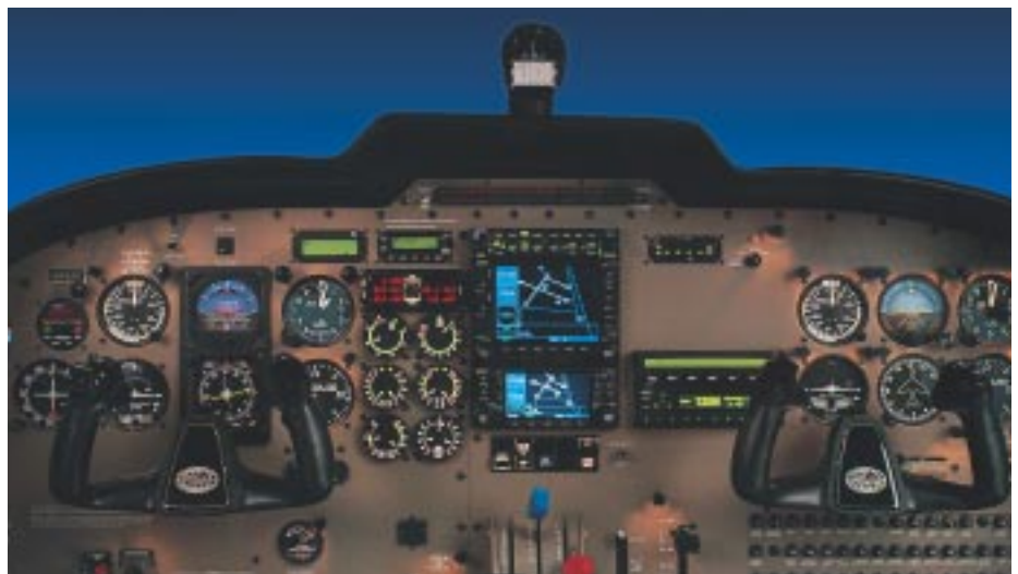
Les tout derniers modèles sont équipés Garmin, avec double GMS 430 et GMS 530. Le pilote est un S-TEC55.
